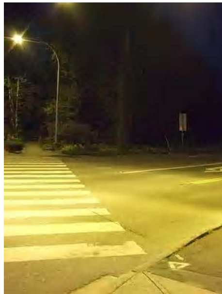
Exemple d'un éclairage amélioré à un passage pour piétons et orienté sur la zone de conflits. ( www.flickr.com/photo/femme )
