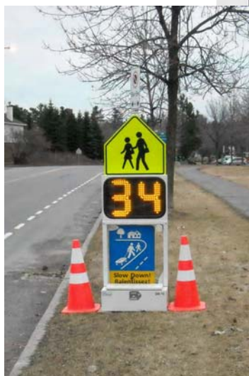
Deux exemples de la façon dont un radar monté sur remorque pour surveiller la vitesse favorise la sensibilisation et le respect des règlements en indiquant aux automobilistes leur vitesse actuelle par rapport à la limite de vitesse affichée. (Ville d'Ottawa)
