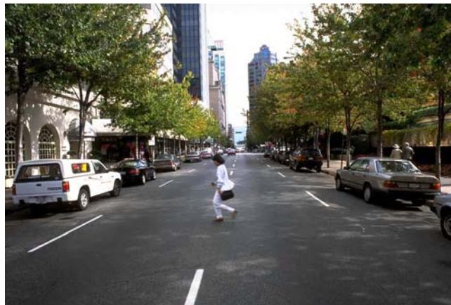
Exemple d'un passage pour piétons sur une rue à voies multiples de circulation à sens unique. Dans une telle situation, les piétons n'ont besoin de porter attention qu'aux véhicules se déplaçant dans une seule direction. Par contre, l'établissement d'un sens unique peut inciter les automobilistes à circuler plus grande vitesse. ( www.pedbikeimages.org/ Dan Burden)
