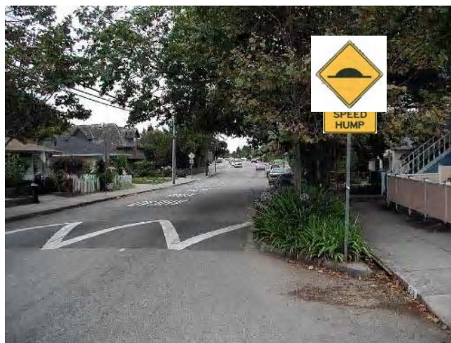
Les bosses de décélération et les bosses de ralentissement de type trapézoïdal sont fréquemment utilisées comme mesure pour réduire à l'avance la vitesse des véhicules qui se dirigent vers un passage pour piétons. (Dan Burden / McCormick Rankin)
