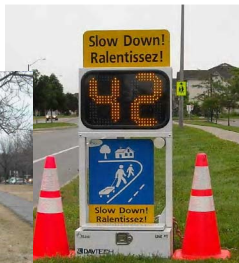
Deux exemples de la façon dont un radar monté sur remorque pour surveiller la vitesse favorise la sensibilisation et le respect des règlements en indiquant aux automobilistes leur vitesse actuelle par rapport à la limite de vitesse affichée. (Ville d'Ottawa)
