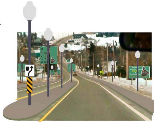
Concept d'un point d'entrée et de mesures de contrôle de la vitesse sur une artère qui divise une collectivité. (McCormick Rankin Corporation rendering)
