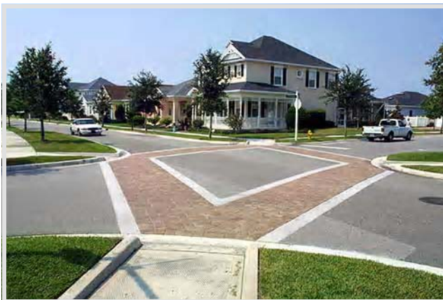
Des passages pour piétons texturés ou colorés se démarquent du revêtement asphalté et sont plus visibles pour les automobilistes. ( www.pedbikeimages.org/ Dan Burden)
